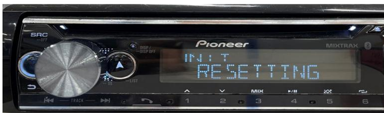
12. Maintenez enfoncée la touche SRC/OFF pour régler la source de l'appareil sur OFF.
