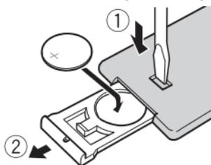
Insérez la pile CR2025 (3 V) avec les pôles plus (+) et moins (-) orientés correctement.
